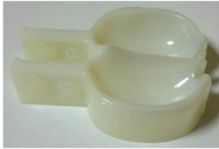
Paleta Pelton înainte de eliminare material suport
